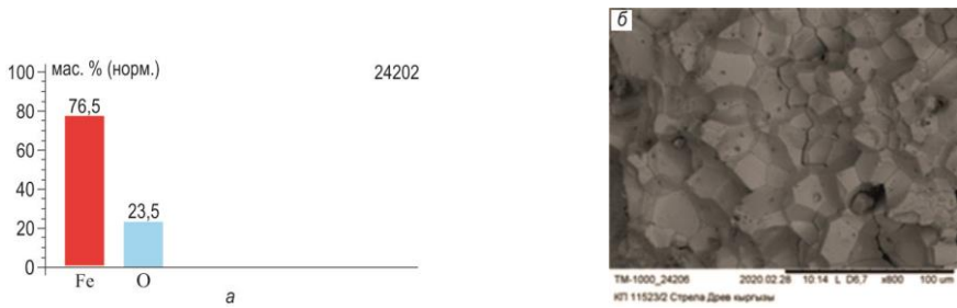
Рисунок 4. Элементный анализ (а) и микрофотография внутренней структуры (б) стрелы (древние кыргызы)
